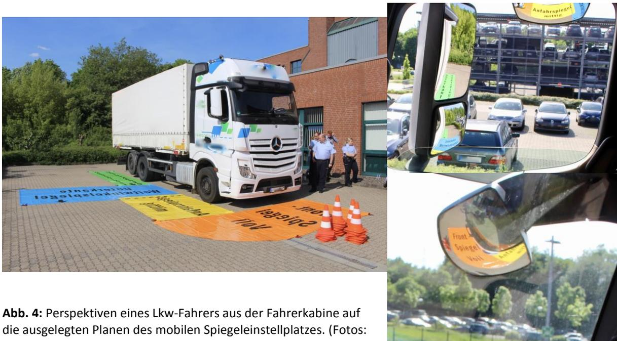
**Abb. 4:** Perspektiven eines Lkw-Fahrers aus der Fahrerkabine auf die ausgelegten Pläne des mobilen Spiegeleinstellplatzes. (Fotos: M. Lauterbach 2017)
